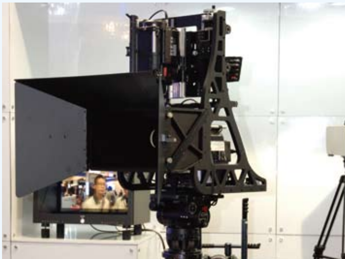
[그림 4] 개발 중인 직교식 카메라 리그 시스템
